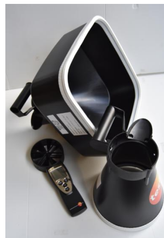
Anémomètre à cônes d'analyse des débits d'air
